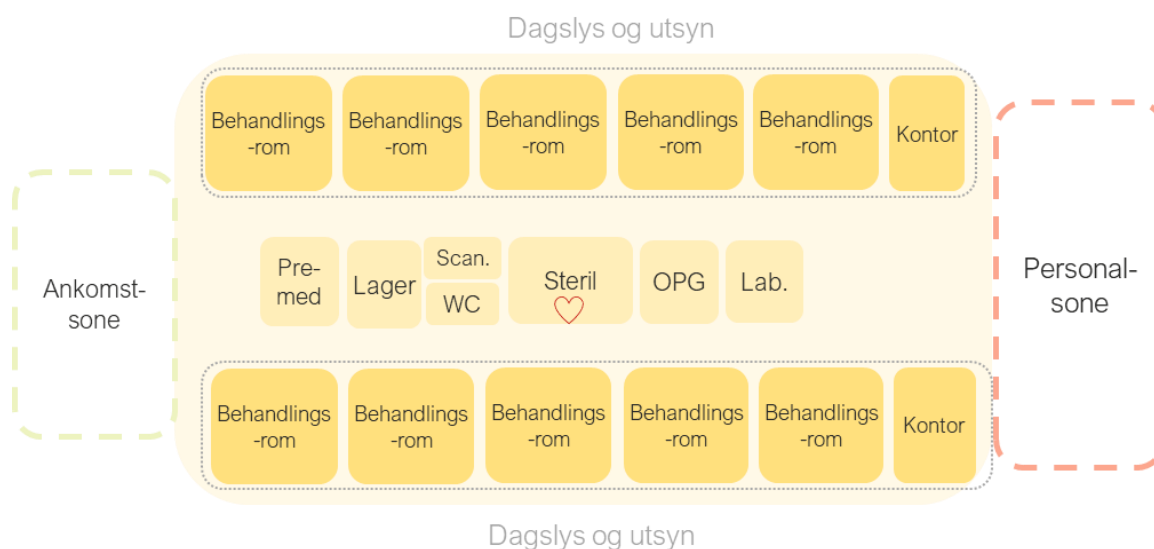
Figur 4 Nærhetsdiagram funksjoner i behandlingssonen. Behandlingsrom og kontorer krever dagslys og utsyn, og må ligge til fasade. Hvilerom/premed.rom, lager, toalett, scanstasjon, steril, OPG og lab trenger ikke dagslys og utsyn, men må ligge sentralt tilgjengelig fra behandlingsrommene, gjerne i en kjerne av bygget.
