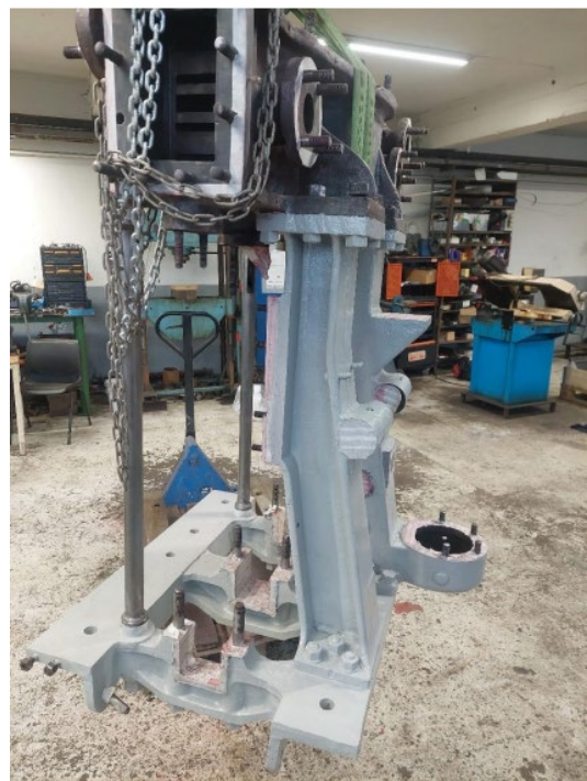
Tyrv i ferdig rengjort og primet
