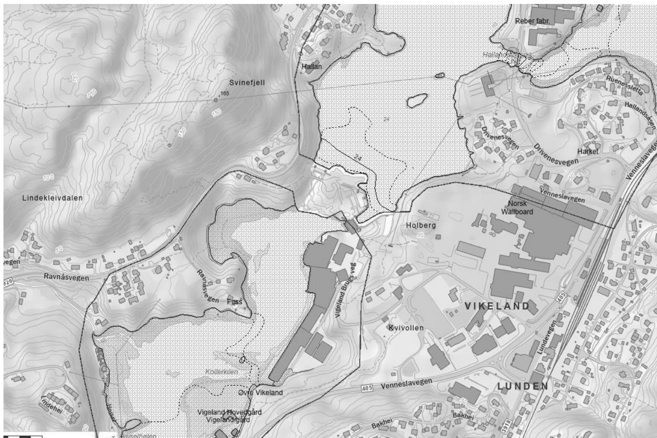
Figur 3-7. Flomsonekart for 200-årsflom ved Vigelandsfoss kraftverk. Blå og rød skravur er hhv. uten og med klimapåslag.
