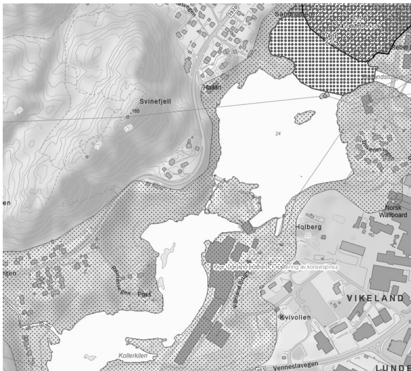
Figur 3-10. Aktsomhetsområde for kvikkleireskred (blå skravur) og kvikkleiresone (utløsnings- og utløpsområde med høy faregrad, rødt).
