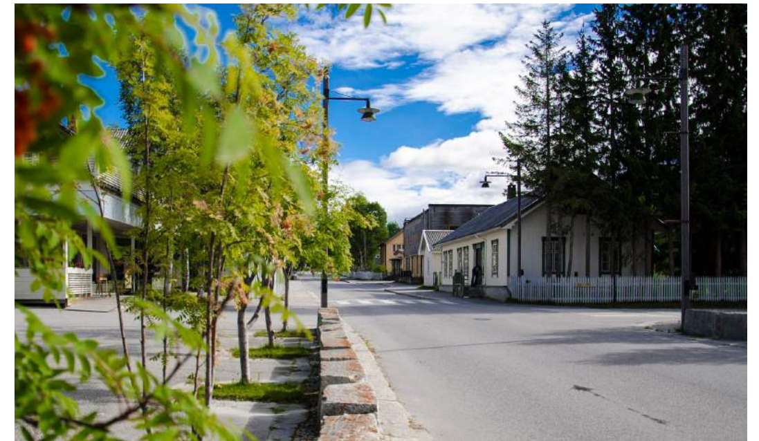
Referansefoto fra Os sentrum i Østerdalen. Gjennom miljøprioritert gjennomkjøring (MPG-prosjekt) på 1990-tallet, ble sentrum opprustet med fortau, granittkanter, stedegne trær, opprusting av den gamle bebyggelsen med tilhørende stakittgjerder og innramming av hagene mellom husa. Foto fra Street view
