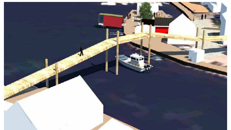
Forlengelse av broa inn på fastland gir slakere kurvatur og mer klaring ned til vannet
