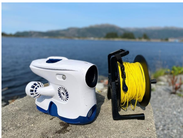
Figur 2: ROV type Blueye Pioneer som ble brukt for å kartlegge tiltaksområdene.
