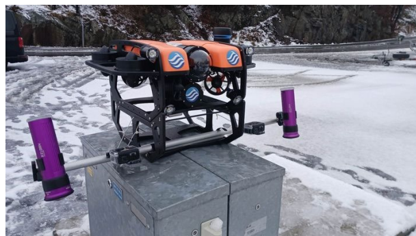
Figur 2. BlueRov2 med fotogrammetrigrigg.
