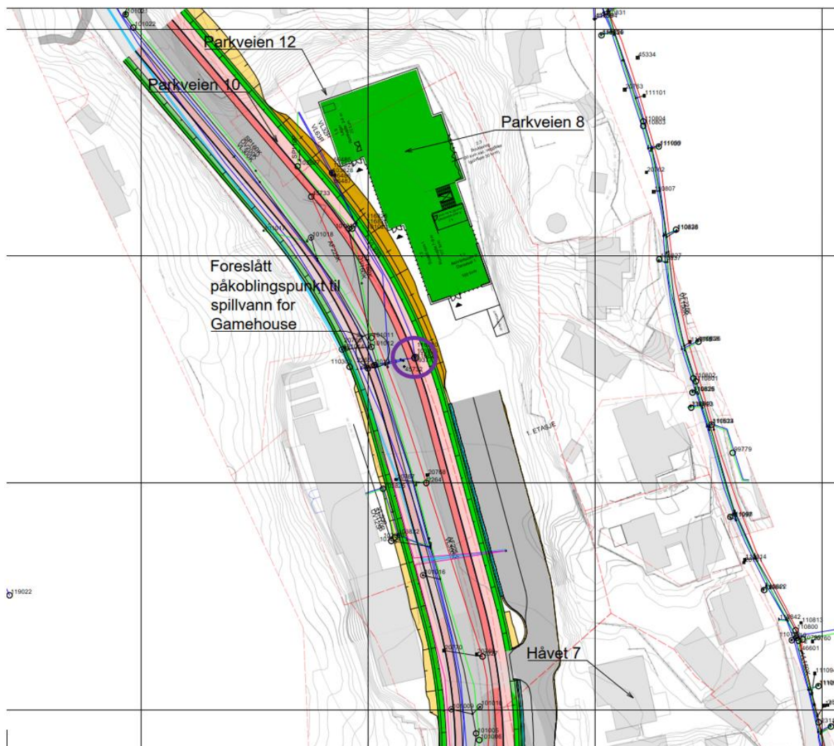
Figur 7: Påkoblingspunkt for spillvann markert med lilla sirkel.
