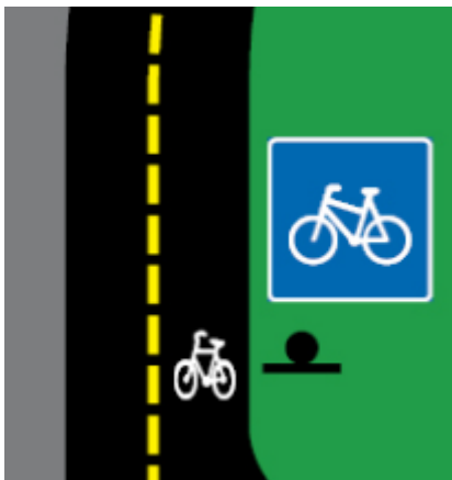
Figur 5 Eksempel på bruk av 1002 «Varsellinje» for å skille syklende i forskjellige retninger på sykkelveger (fra N302)
