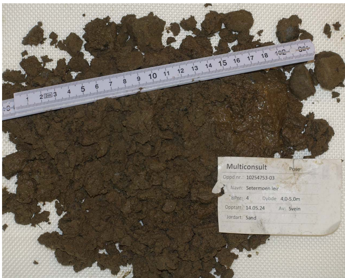
Figur 4-3: Poseprøve med sandig, siltig materiale, fra 4-5 m i BP. 4.
