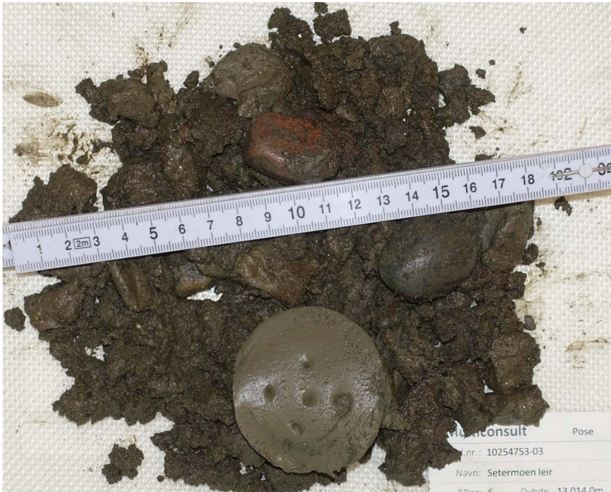
Figur 4-4: Poseprøve fra 13-14 m dybde i BP. 6-24. Korngradering viser sandig, siltig, leirig materiale.
