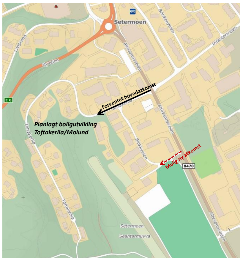
Figur 6-2: Planlagt boligutvikling på Toftakerlia og Molund har antakeligvis hovedatkomst via kryss Toftakerlia x Altevannsveien (sort pil). Da det forventes en høy trafikkøkning i området grunnet antall boliger som skal bygges i framtidig situasjon, kan ny atkomst etableres via kryss Blokkveien x Altevannsveien som en avlastning (rød pil).
