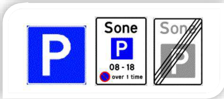
Figur 4: skilt 552 "parkering", skilt 376 "parkeringszone" og skilt 378 "slutt på parkeringszone"
