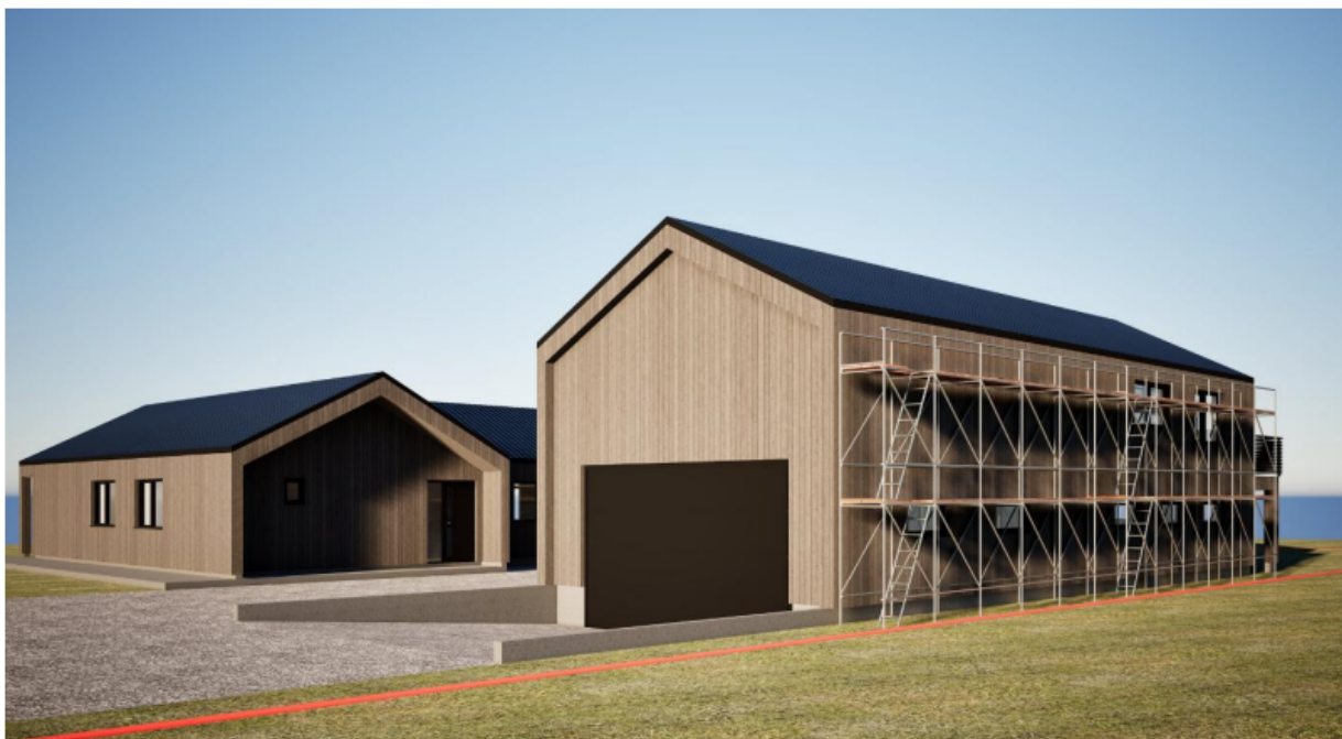
FIGUR 1 EKSEMPEL PÅ STILLAS NØDVENDIG FOR VEDLIKEHOLD. RØDSTREK VISER EIENDOMSGRENSE
