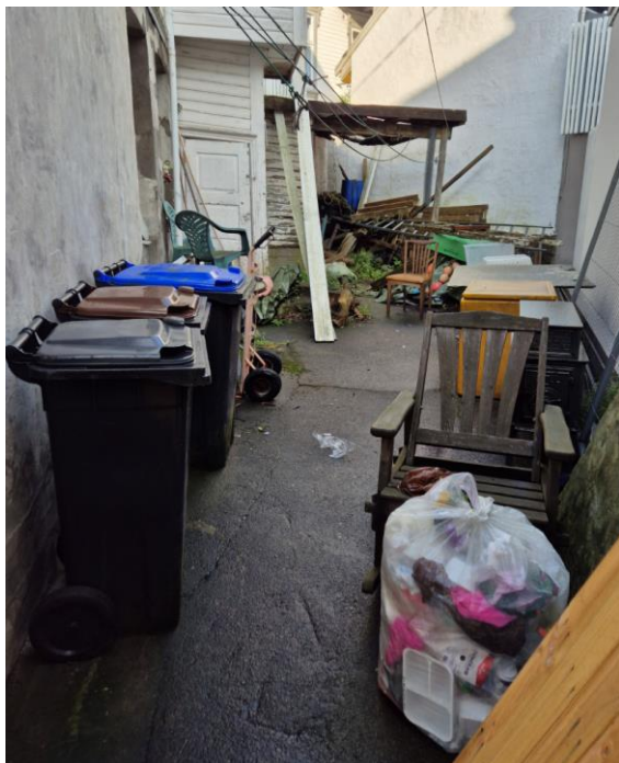
Figur 24: Eksempel på utvendig brennbart materiale mellom bygninger.
