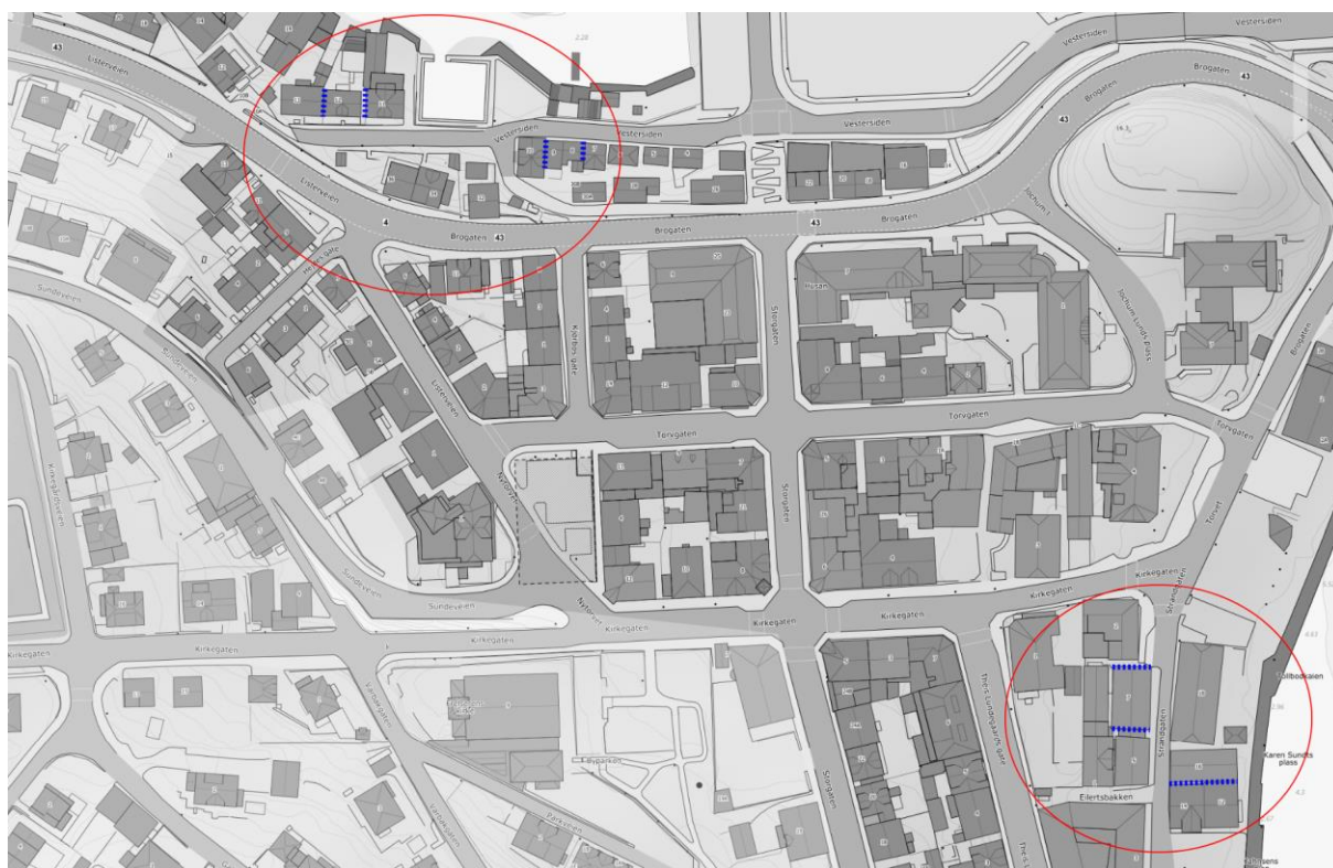
Figur 34: Kartillustrasjon viser anbefalt plassering av fasadesprinkler.
