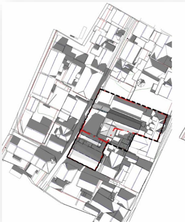
FIGUR 4: SKYGGEMÅLING KL. 15.00 VED VÅRJEVNDØGN.
