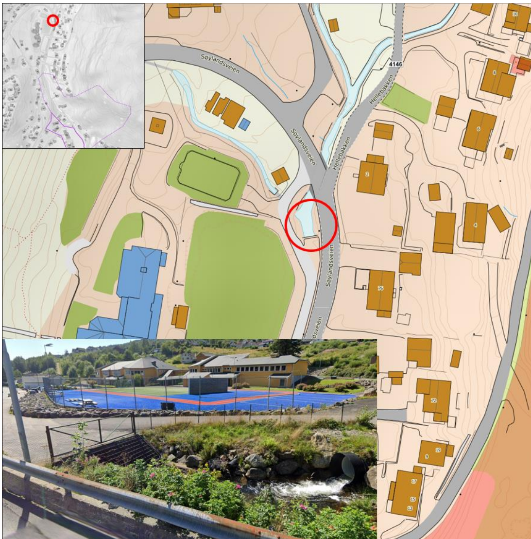
Figur 15: Risten i Tjørsvågbekken som sporadisk åpnes opp og fører til massebevegelse av opphopede blokker og organisk materiale - ifølge lokal beboer.
