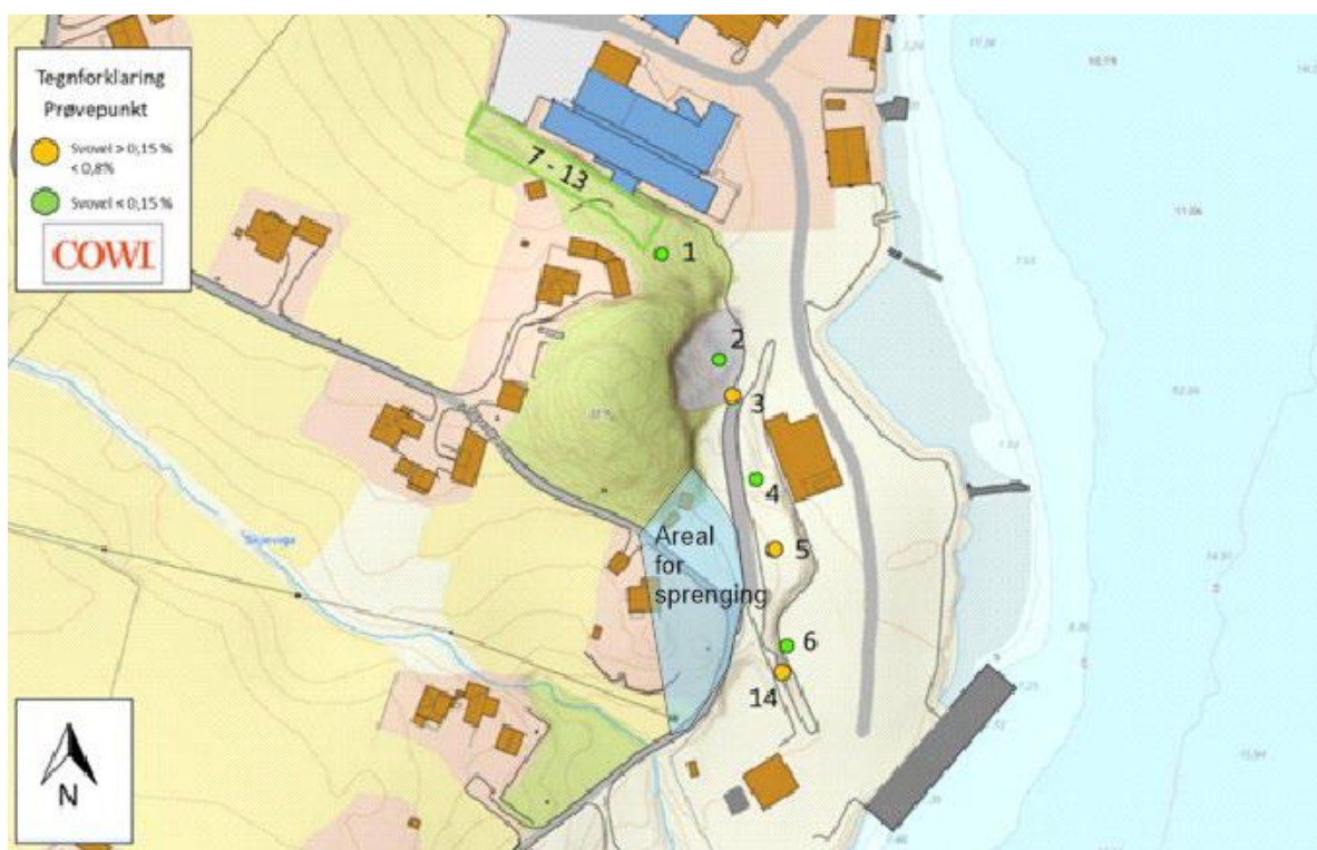
Figur 12 Fra notat av mars 2024 fra COWI, vist i vedlegg. Figuren er justert ved at aktuelt område for sprenging er markert med blått areal. All analyse av berggrunn i området, vist med grønne og gule punkter, viser berggrunn med lavt innhold av sulfid. Gjennomsnittsverdi for området er svovel på < 0,1 %. Det konkluderes med at bergartene i området har lite eller ingen potensiale til å generere sur avrenning ved utsprengning i notatet fra COWI av mars 2024.
