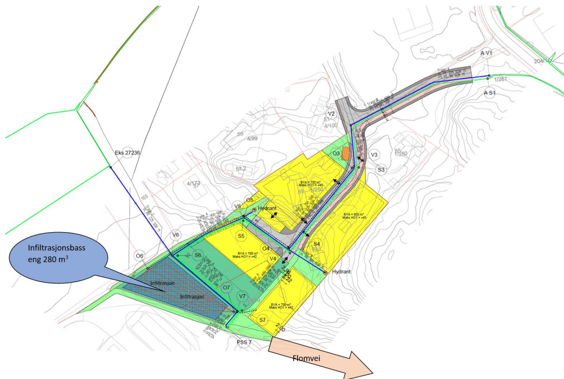
Kartet viser infiltrasjonsbasseng og nødoverløp
