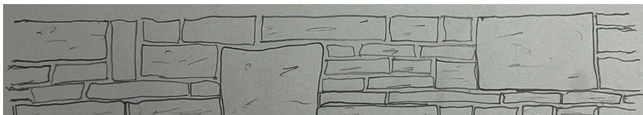
Figur 20 Oppbryting av horisontale fuger
