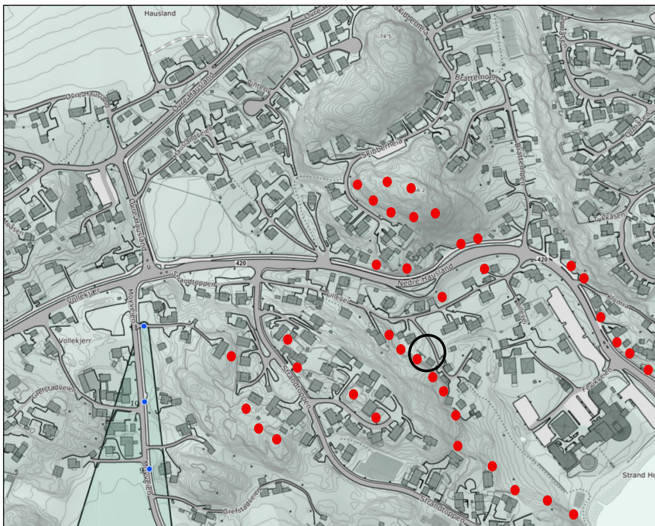
Figur 2-2 Oversiktskart fra NADAG med tidligere grunnundersøkelser. Røde prikker markerer observasjon av berg i dagen fra flyfoto. Sort sirkel markerer ca. tiltaksområdet.
