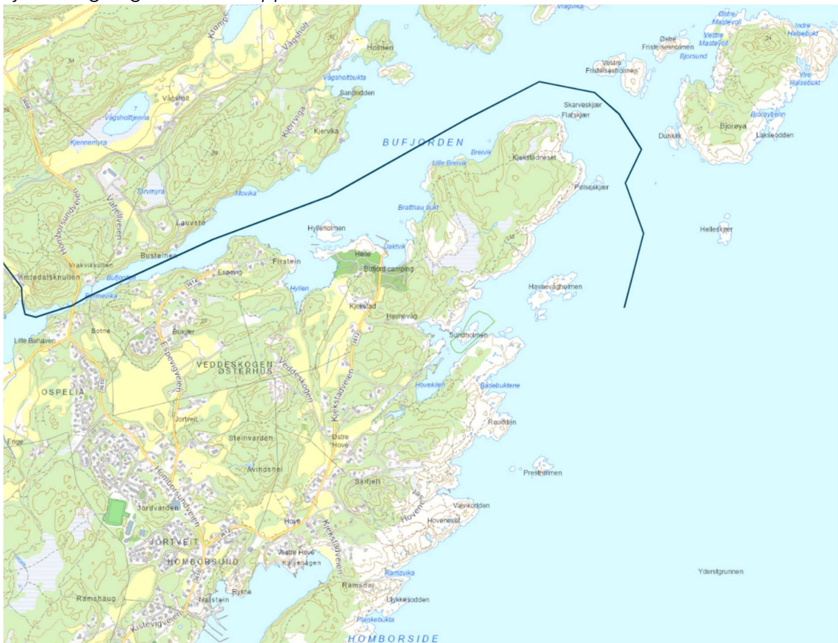
Figur 35: Sjøledning Engekilen til utslippssted
