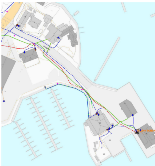
Figur 4-30: Kartskisse som viser eksisterende høy/lavspennings kabelnett og nettstasjon på holmen fra Agder energi.
