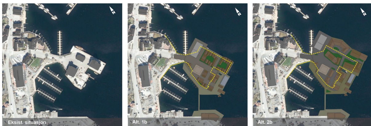
Figur 6-5: Utredningsalternativ 1 og 2 innebærer ulik grad av utvidelse av Torskeholmens areal. Stiplet, gul strek markerer dagens kaifront.
