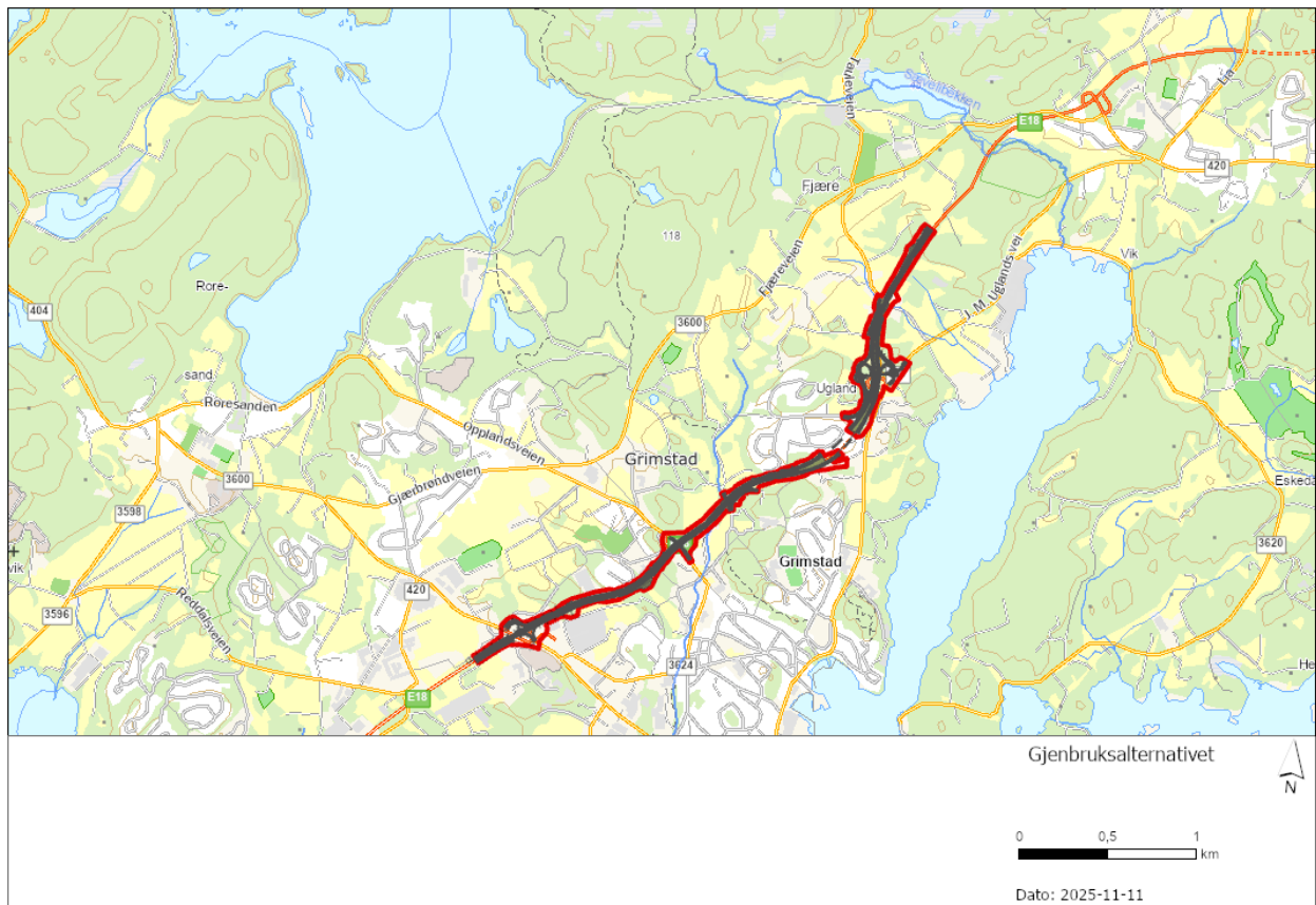
Figur 2-18 Viser anleggsbelte og veillinje for gjenbruksalternativet i rødt. Veilinja er markert med grått. Det stipla grå området illustrerer tunnel. Gule arealer tilsvarer fulldyrka jord.
