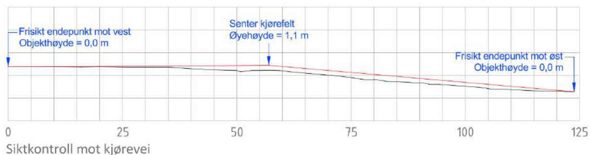
Figur 11 Avkjørsel mot Hesnesveien, siktkontroll mot GS-vei
