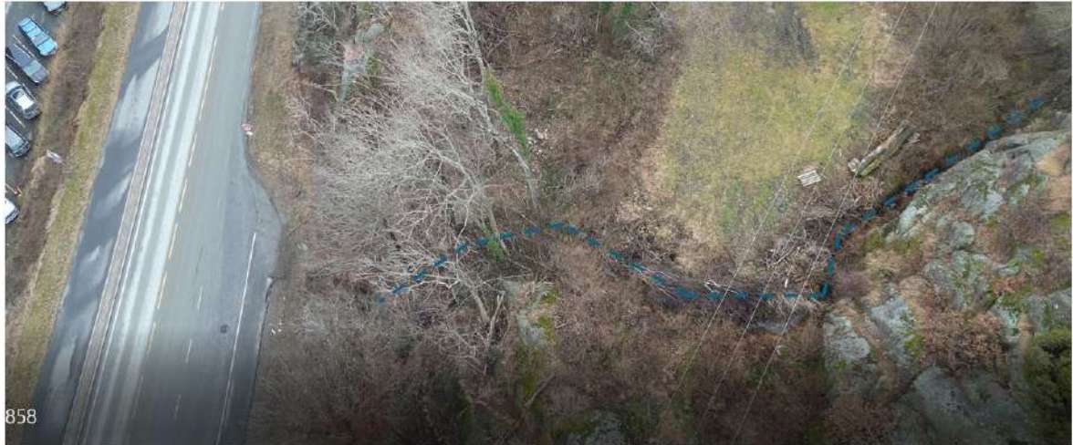
Figur 3-7: Dronefoto som viser terrenget ovenfor det sørligste bekkefaret ett vest for Nymo verftsområde. Blå stiplete linjer indikerer dreneringsvei. (Foto: COWI).
