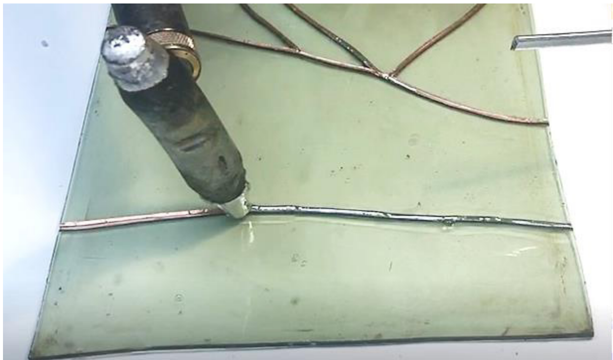
Foto fra utføringen av en reparasjon med kobberfolie. Loddetinn legges langs kobberfoliebøten med en loddebolt.
