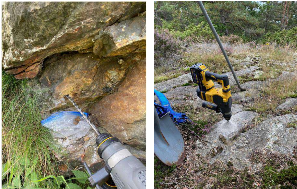
Figur 3-3: Prøve nr. 2 på bildet til venstre. Prøve nr. 12, fjellbløtning i pegmatitt på bildet til høyre
