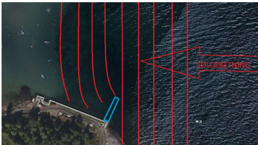
Figur 5. Skisse som illustrerer hvordan bølger vil «avbøyes» ved enden av fyllingsmolo, og treffe kaia bak. (Dagfin Skaar AS/ Kystinfo))
