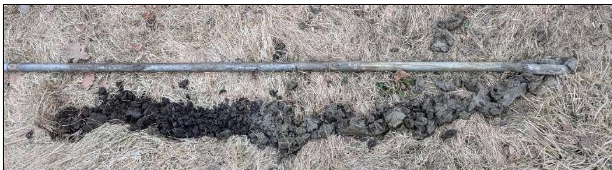
Bilde 5) Prøvetaking fra 4 lokaliteter viste jord ned til 50-120cm, leire ned til >220cm. I prøvepunkt 1 ble fjell påmøtt ved 240cm i punkt 2 var leiren steinrik ved 220 og punkt 4 møtte fjell ved 180cm.
