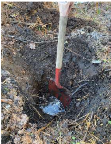
Gravehull øverst på tomt. Grunnvann ved 60cm.
