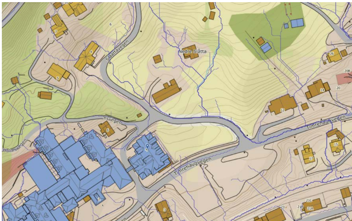
Figur 10 - Avrenningsmønster eksisterende situasjon (illustrert med blå avrenningslinjer)
