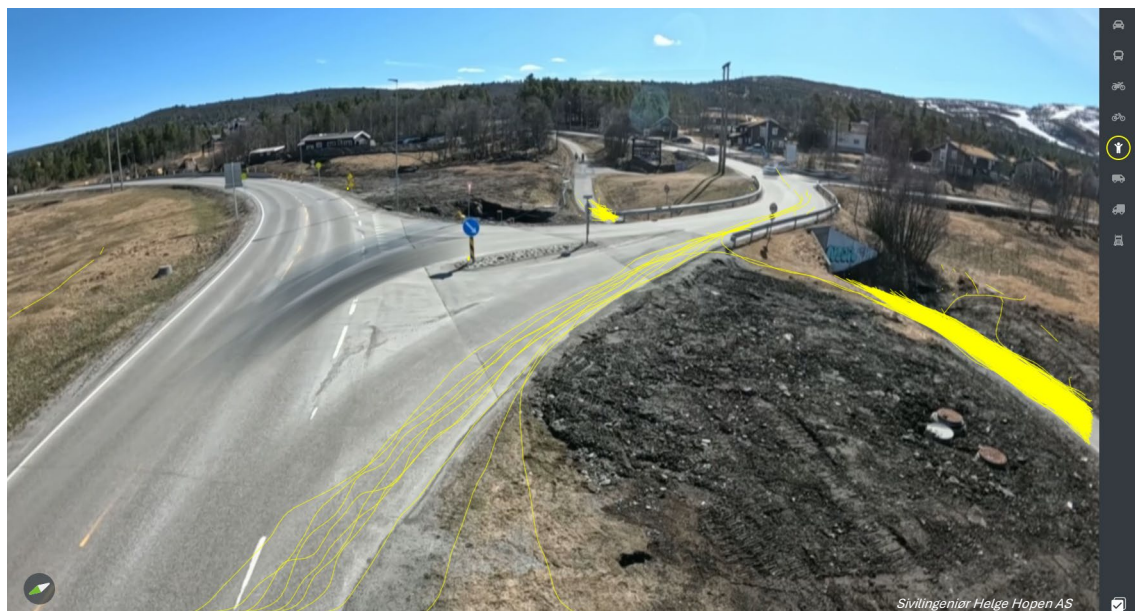
Figur 13. Illustrasjon av gangtrafikken i måleperioden på ca. 5 timer langfredag 18.4.2025. Målingen viser ca. 62 gående pr. time i kulverten under Stølsvegen, og 2 gående/joggende pr. time langs veien.
