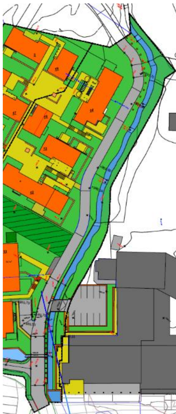
Figur 6 Åpen bekk langs Osestølvegen som en del av flomsikringen lagt til grunn kart og bestemmelser.
