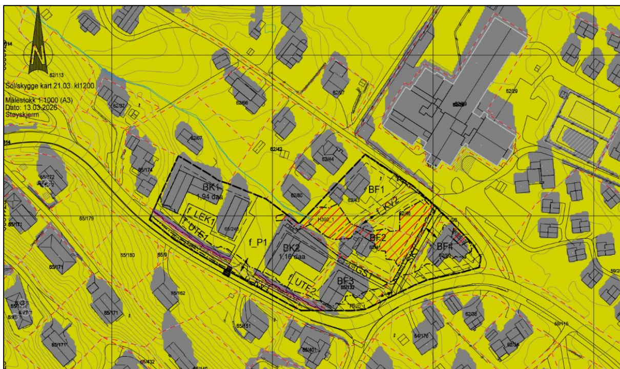
Figur 13: sol-/skyggeanalyse 21.03.kl.12, med støyskjerm og monopolbygg på BK1 og BK2 (maks. utnyttning).
