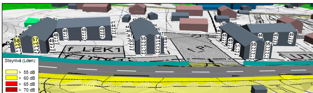
Figur 4-3: L_{den} fasadestøynivåer med støyskjermer langs veg.
