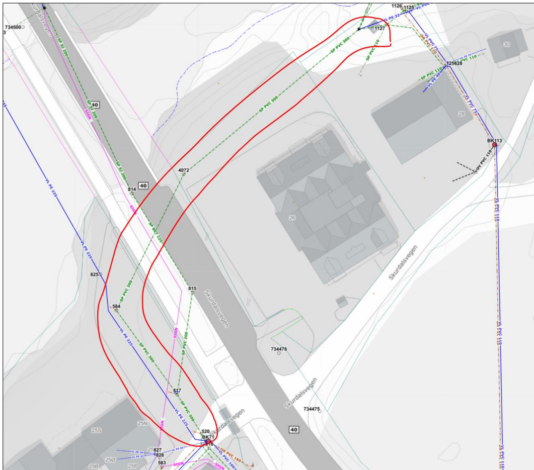
Figur 19. Spillvannsledning fra kum 520 har dimensjon Ø300 (trolig Ø315).
