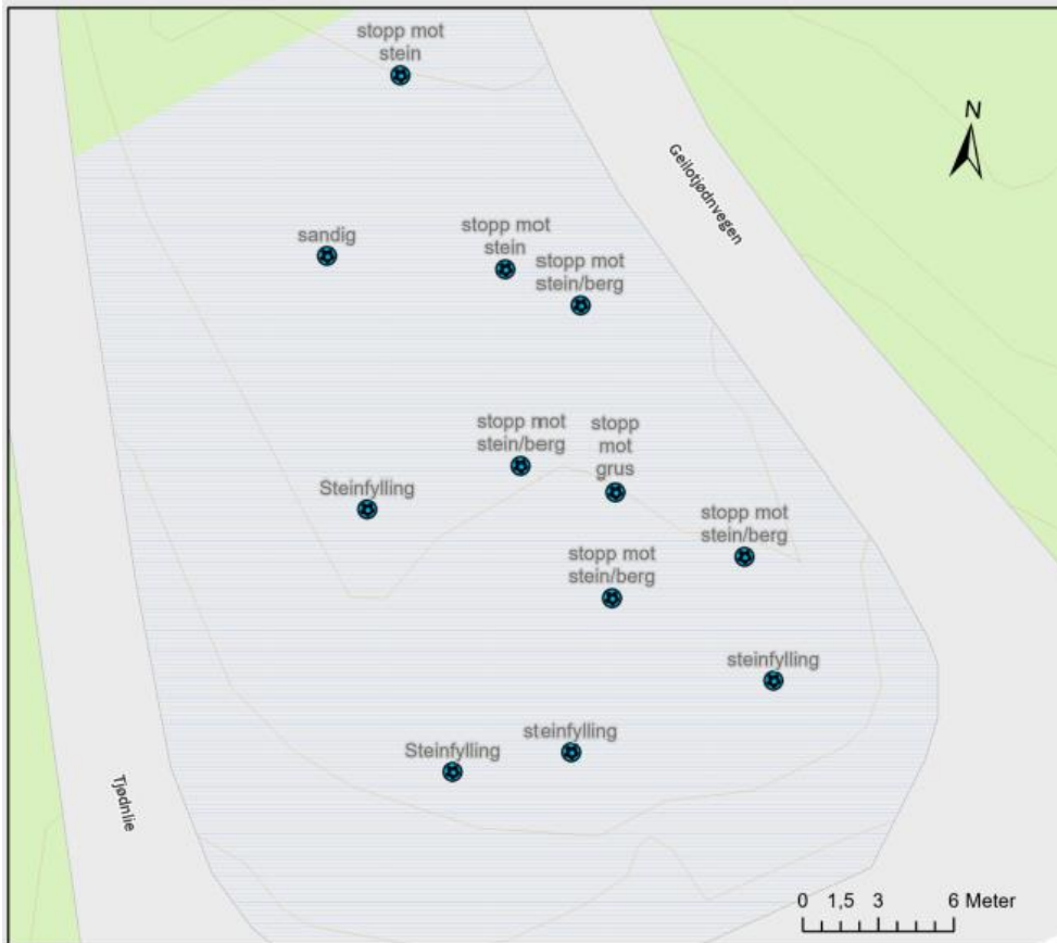
Figur 13: Overgang mellom myravssetninger og underliggende masser registrert med stikkstang.
