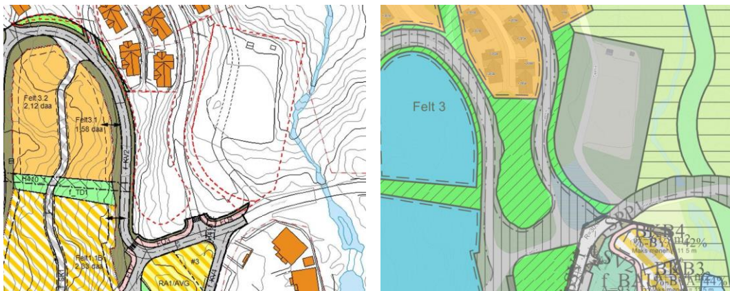
Figur 10: Plankart med rødstiplede linjer som viser gjeldende formålsgrenser for parkeringsplass B og annet regulert vegformål til venstre. Illustrasjon til høyre er utsnitt fra kommune kart.no, med gjeldende planstatus.
