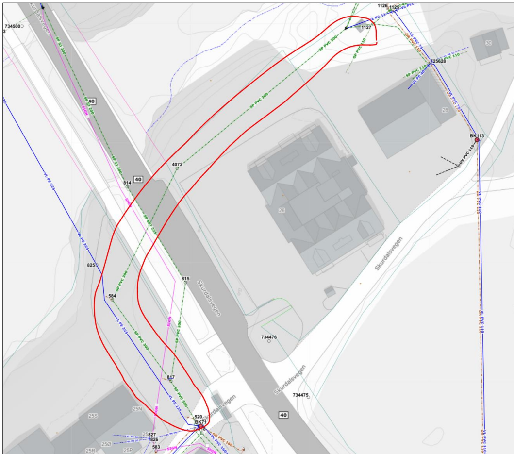
Figur 19. Spillvannsledning fra kum 520 har dimensjon Ø300 (trolig Ø315).
