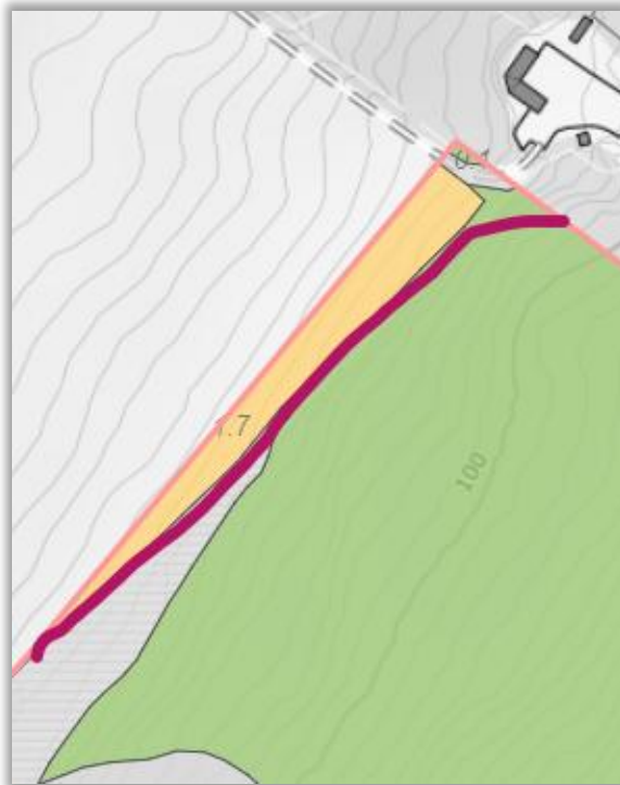
Utklipp 6.2.3.1.1: Planavgrensningen er lagt i arealbruksgrense vist med påtegnet mørkerød strek, bekken ligger øst for den påtegnede streken. Kilde: gardskart.nibio.no
