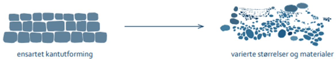
Figur 6 Illustrasjon viser tradisjonell utforming av fyllingsfot, versus variert fyllingsfot som legger til rette for marint biomangfold. (Hentet fra: Konsekvensutredning naturmangfold og vannmiljø (Skaar, 2026))
