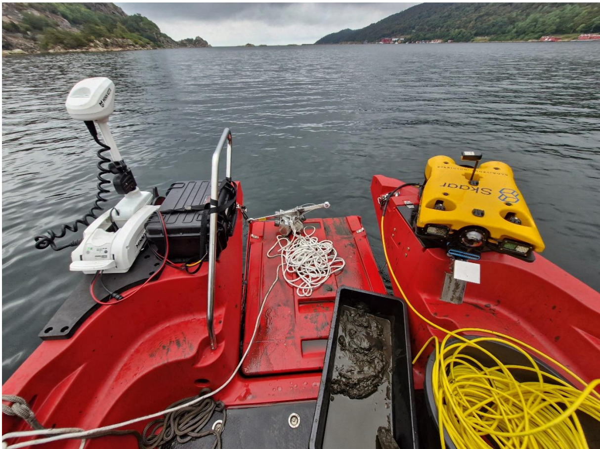
Figur 8. Prøvetakingsoppsett med van veen Grabb og ROV med fangarm. Foto: L. Esdar, Skaar AS, 2025.
