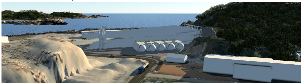
Figur 17 3D-modell viser planlagt tiltak. Etter terrengarrangering av Areal 1 (kollen) tilrettelegges området for bruk som opplagsplass for elementer.
