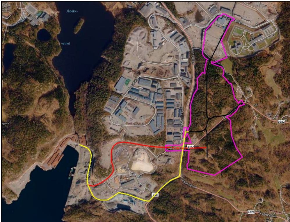
Figur 12. Flyfoto som viser vei og anleggs-situasjonen i forhold til reguleringsplanen for Jåbekk sør. Sort linje viser nye veier i Jåbekk sør industriområde og tilhørende omlegging av Tofteveien. Gul linje viser fremtidig trafikkmønster mellom Jåbekk sør og Strø
