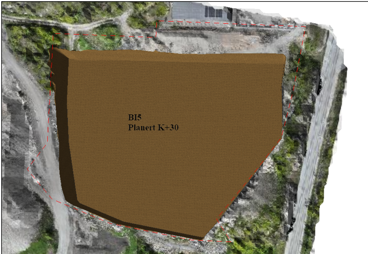
Figur 7: B15 (nå øvrige anlegg) planert kote +30, rød stiptet linje er omriss av B15 (Kilde: TT anlegg)
