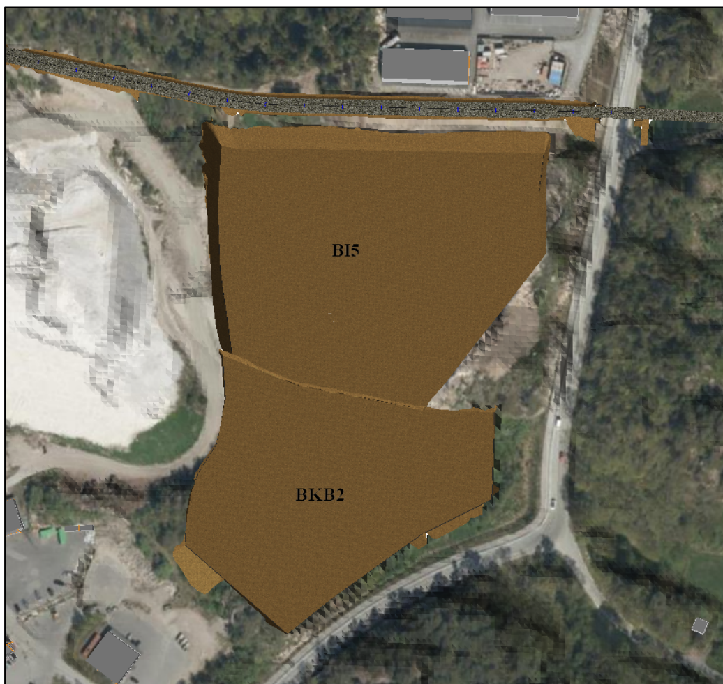
Figur 10: B15 planert kote +30 og BKB2 på kote +40 (Kilde: TT-anlegg)
