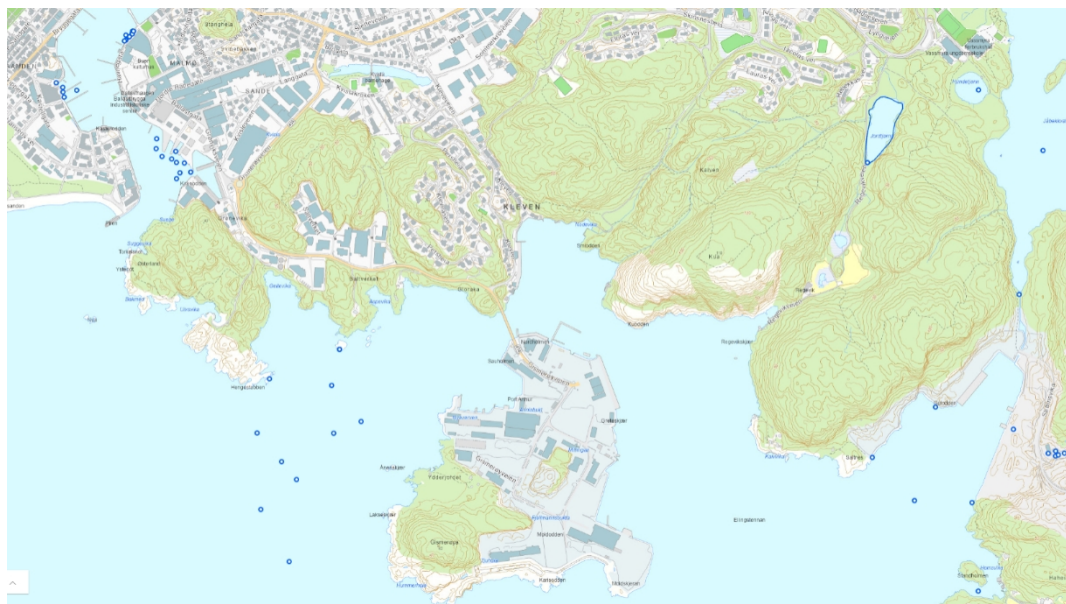
Figur 5-1: prøvepunkter for miljøgifter i området registrert i vannmiljødatabasen til Miljødirektoratet. Strømsvika er nederst til høyre, mens Mandal er øverst til venstre. Det er registrert høye verdier av tilsvarende PAH-forbindelser i sedimentprøver tatt ved elvemunningen i Mandal.
