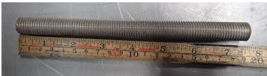
Figur 4) Den rustfrie pinnen er 19 cm lang, gjenget og har en diameter på 15 mm.
