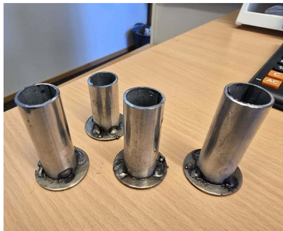
Figur 6) Foto t.v.: Skiferplate nederst av basen. Hullene var allerede boret tidligere. Inne i sandsteinen var de sirkulære i tverrsnitt, mens de ytre åpningene i skiferen var firkantede. Foto t.h.: Det ble derfor laget metallhylser som passet tett inn i åpningene. Disse ble senere kappet ned.
