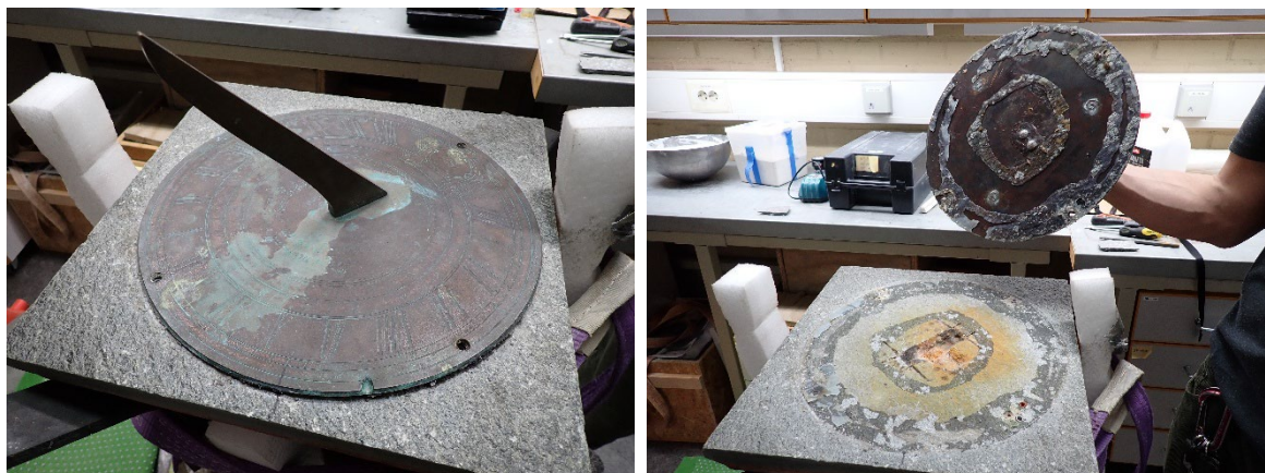
Figur 12) Foto t.v.: Solurskiven i messing hadde fått anløpning som følge av værpåvirkning. Foto t.h.: Den var tidligere festet til soluret med silikon. Skiven ble forsiktig løsnet, ble rensed og polert.
