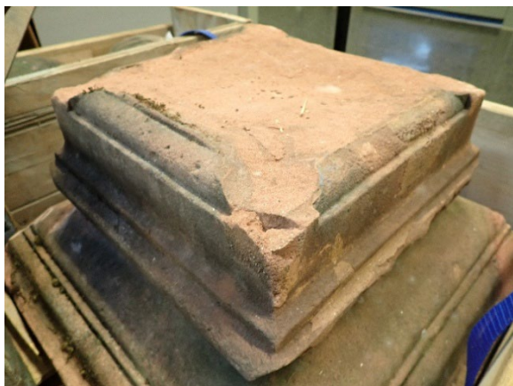
Figur 2) Rent brudd i overgangen mellom basen og resten av søylen. Foto t.v.: Før overflaten ble boret. Foto t.h.: Etter behandling med en pinne plassert i midten.
