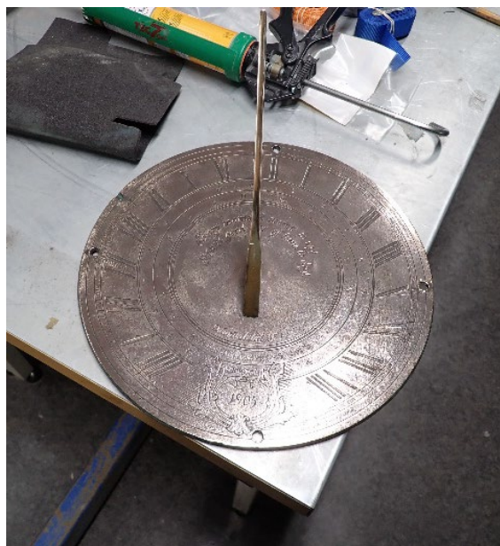
Figur 13) Foto t.v.: Skruene ble forsiktig demontert, rensed, polert og gjenbrukt. Foto t.h.: Skiven ble rensed og polert.
