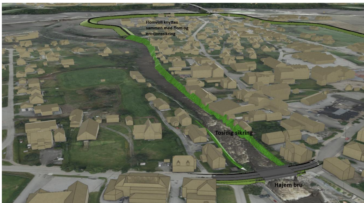
Figur 42. Utsnitt fra modellen viser flomsikringen i grønt, nedstrøms Hajem bru.
