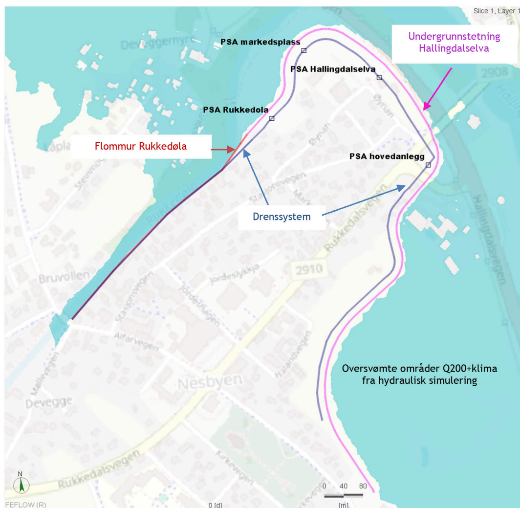
Figur 9.1 Elementer i flomsikringskonseptet for Nesbyen
