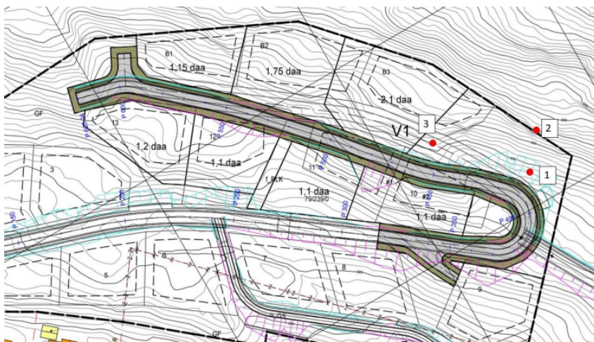
Figur 3. Oversiktskart fra rapporten viser de tre observerte områdene med potensielt ustabile bergpartier markert med røde punkter. 1) Avløst flak, 2) Avløst blokk og 3) Avløst større bergparti. NB! Inntegnet veg i grått er ikke siste versjon av ny trase. Sorte linjer viser avgrensning av gjeldende planformål.
