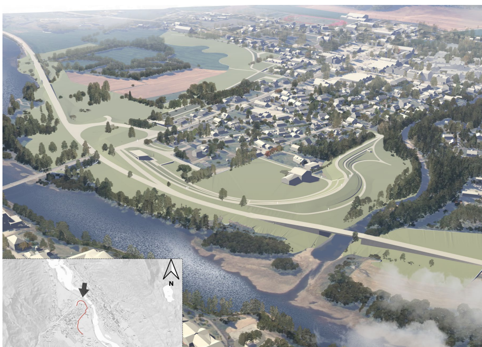
Figur 21: Fugleperspektiv – viser flomvoll sett fra motsatt side av Hallingdalselva – sett i retning Hallingmarken.
